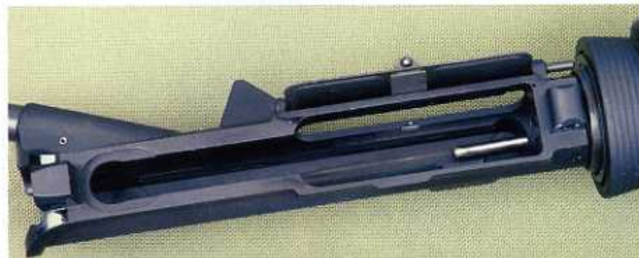
L'interno dell'upper, con il terminale del tubetto del sistema diretto di presa gas e la scanalatura di scorrimento della manetta di armamento a "T".
