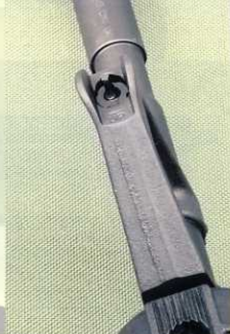
Sopra: il mirino a palo, regolabile in altezza e protetto da alette.
