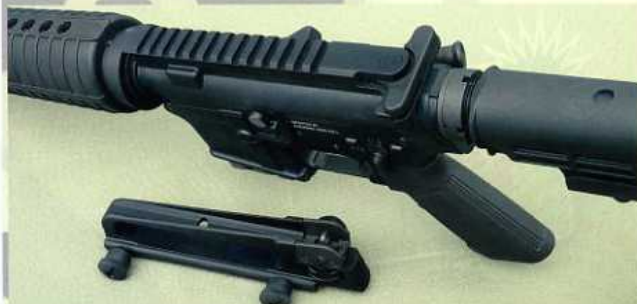
Sopra: allentando le due viti laterali si può rimuovere il maniglione, scoprendo la slitta Picatinny per il fissaggio di ottiche o red dot.
