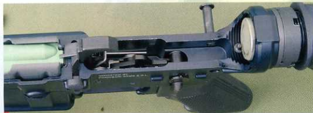
Sopra: allentando le due viti laterali si può rimuovere il maniglione, scoprendo la slitta Picatinny per il fissaggio di ottiche o red dot.
