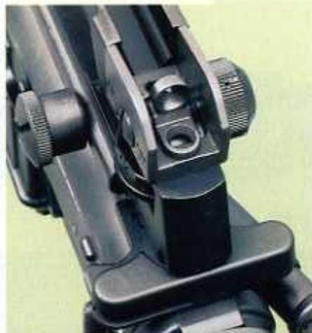
La diottra a "L" sulla sommità del maniglione è regolabile in altezza e derivazione.
